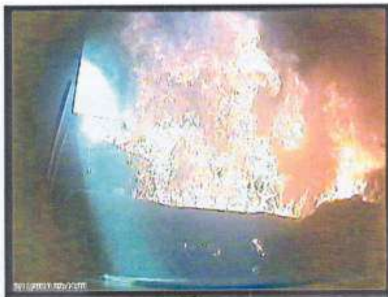
Figura 5.4 – Atuação plena do fogo no interior do protótipo, às 09:44:04h ou 7 minutos do início do ensaio.
