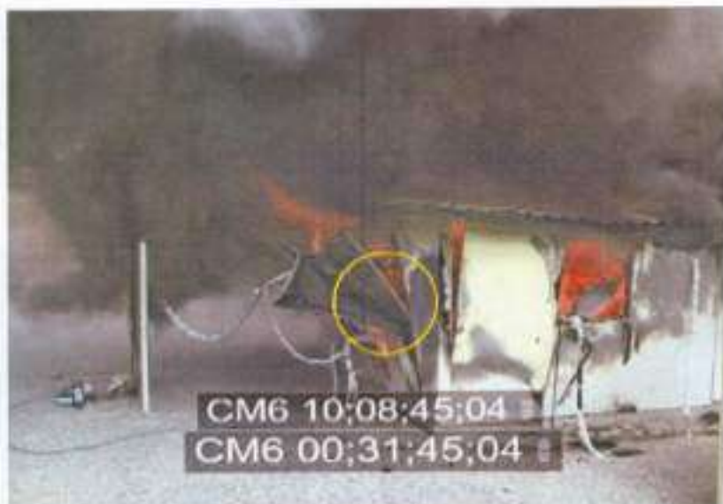
Figura 5.7 – Momento da ruptura do cabo tensor superior do protótipo.
