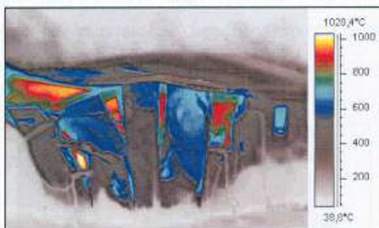
Figura 4.9 – Temperatura registrada pelo termógrafo fixo, às 10:08h ou 31 minutos de ensaio, quando houve o colapso da estrutura.
