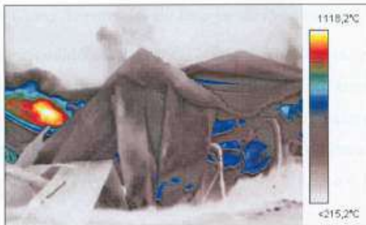
Figura 4.12 – Temperaturas captadas pelo termógrafo fixo, às 10:17h, 9 minutos, após o colapso da estrutura.
